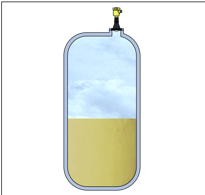
插图. 6: 用 VEGAPULS 61 在一个酸槽中测量液位
